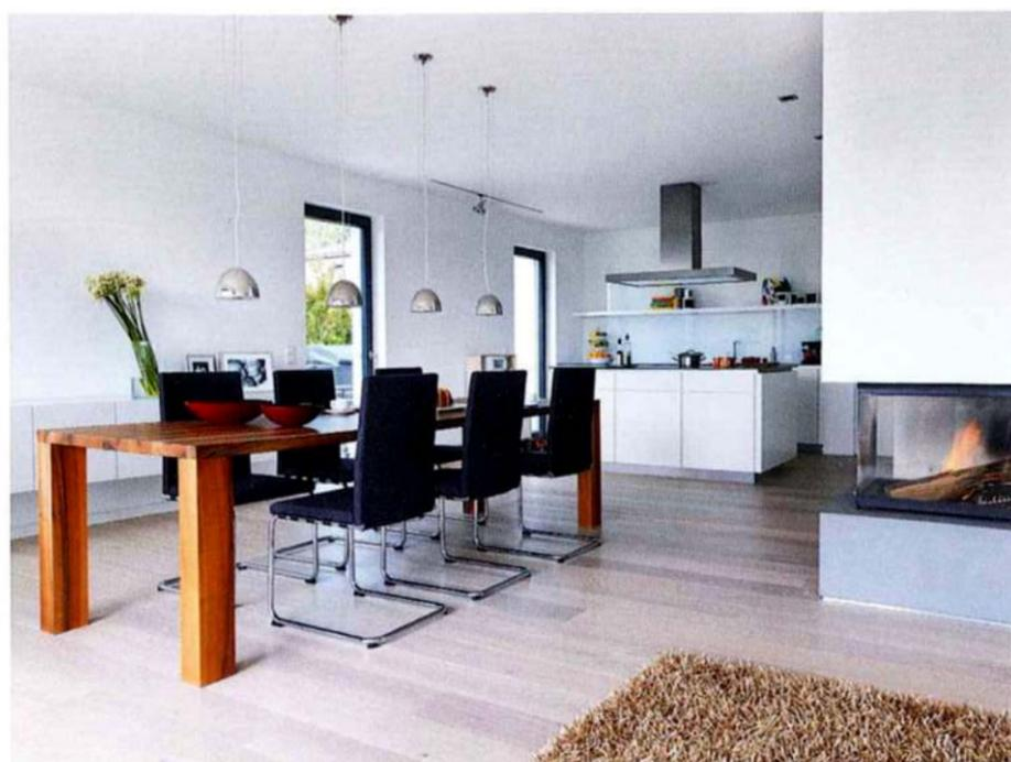
Der Speicherkamin aus einem verglasten Kamineinsatz und einer Verkleidung aus Schamottesteinen unter Putz gibt auch noch Strahlungswärme ab, wenn das Feuer längst erloschen ist.
